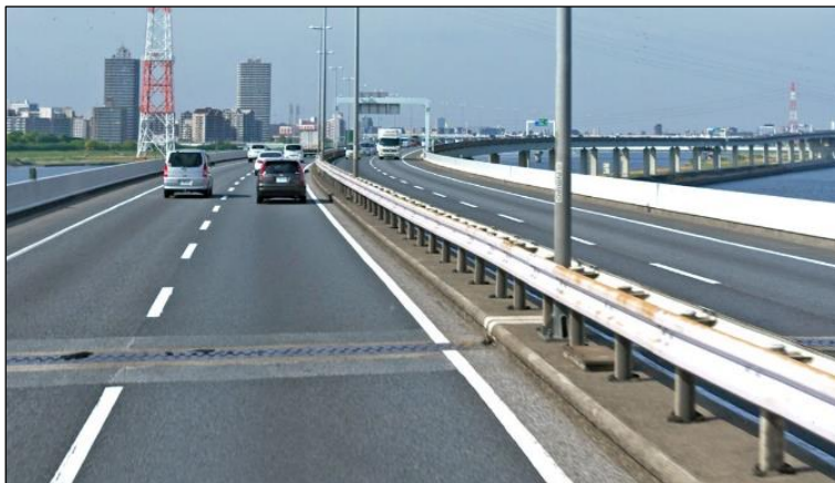
شکل ۴-۵- نمونه میانه با حفاظ طولی نیمه صلب
